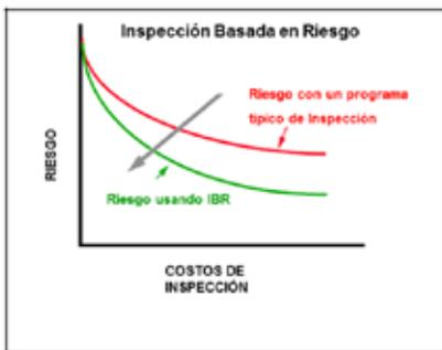
Figura 4. Curva Comparativa ente costos de programas de Mantenimiento entre estrategias basada en riesgo y basadas en condición. Tomada del API RP 580.
