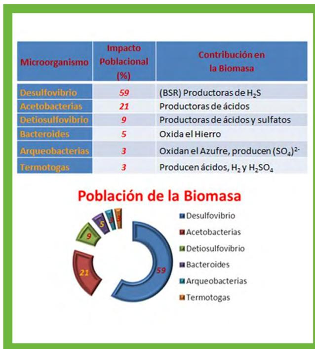
Figura 1 - Los microorganismos se asocian en comunidades que forman biopelículas sobre las superficies metálicas, condición que hace difícil su remoción, y lo que se traduce en problemas dentro de las operaciones. La interacción de estos microorganismos genera la biomasa que ocasiona corrosión en las superficies metálicas.
